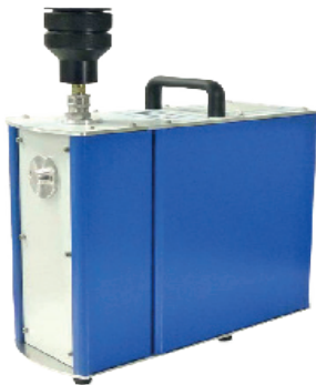
AS 3000 configuré en prélèvement ambiant (prélèvement sur axe vertical)
