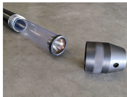
Détail gouge fermée et liner
