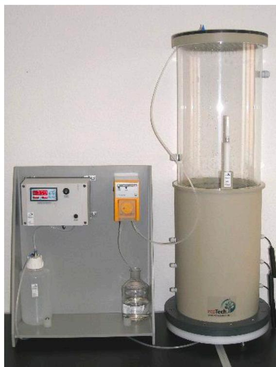
Lysimètre de laboratoire avec tête d'aspersion étendue et contrôleur système pour expériences de flux automatiques
