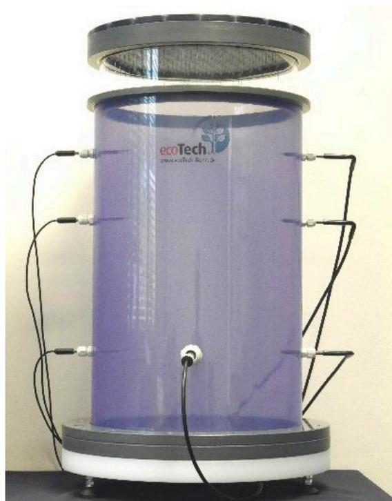
Lysimètre de laboratoire avec tête d'aspersion et capteurs Redox et pH
