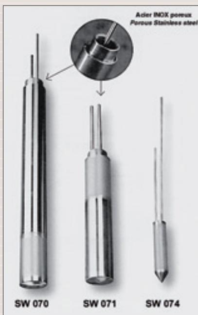
Lysimètres à inox poreux double chambre Ø 51 mm, simple chambre Ø 51 et 25 mm
