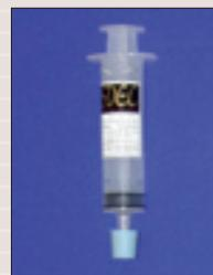
Seringue de préparation pour tensièmètre, à blocage de piston (modèle à gros embout)
