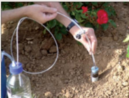
Mise en place du dispositif de collecte SPS300
