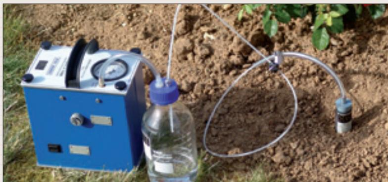
Collecte de la solution du sol d'une SPS200 avec la PAV2000 et un flacon SPS300
