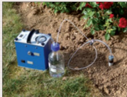
Collecte avec un flacon SPS300 et une pompe à vide de terrain PAV2000
