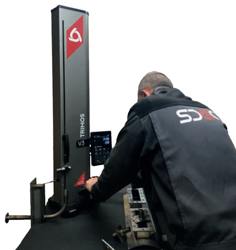
Colonne de mesure sur marbre
