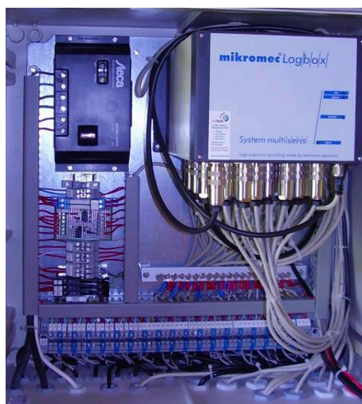
Unité enregistreuse de données pour 18 électrodes Redox, capteurs de température et autres
