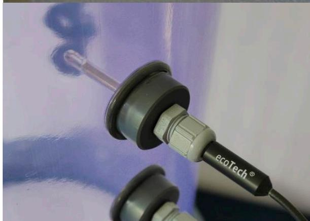
Sonde pH dans la paroi transparente d'un lysimètre de laboratoire, en fonctionnement continu, branché à une unité de connexion Redox/pH sur un enregistreur de données ecoTech enviLog.
