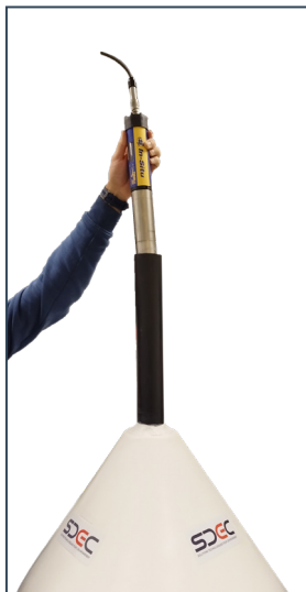
Étapes pour insérer la sonde multiparamètres Aqua TROLL 500
