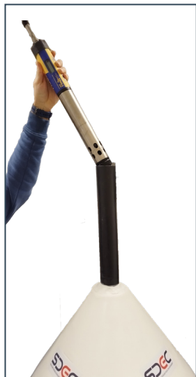
Étapes pour insérer la sonde multiparamètres Aqua TROLL 500
