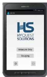
**Ordinateur de jaugeage HydroTab** : Assemblage du logiciel HydroTab et d'une tablette adaptée aux environnements difficiles et humides. Utilisé pour des mesures directes de la vitesse de l'eau, ou pour collecter, calculer, afficher et envoyer par e-mail des données complètes de jaugeage de cours d'eau.
