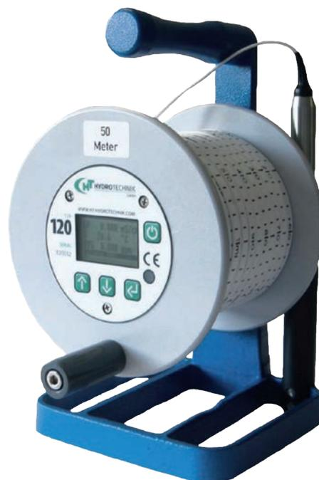
Une LED et un signal sonore sont intégrés pour la signalisation du niveau d'eau. Les paramètres température, conductivité et TDS sont affichés en continu après la mise en marche de l'appareil sur un écran lumineux avec rétro-éclairage.
