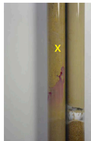
Le colorant de test du produit X fuit à travers la bentonite lors du pompage.
