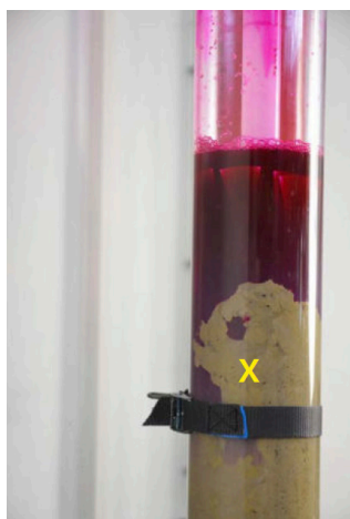
Détail produit X perméable, le colorant test fuit à travers la bentonite lors du pompage.
