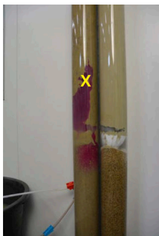
Le colorant de test du produit X fuit à travers la bentonite lors du pompage.
