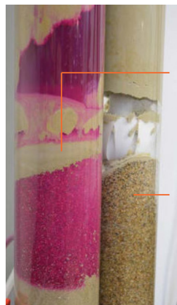
À gauche : le colorant de test du produit X fuit à travers la bentonite lors du pompage et atteint le sable du filtre.
