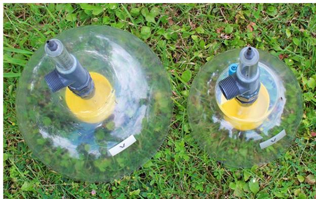
Elle peut être librement définie depuis 0 à la dépression correspondant au point de bullage du sol. La pression est ensuite visible dans le U-Tube grâce au manomètre.
