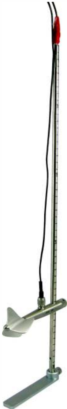
fig. 7, micro-moulinet M1 fixé sur perche de Ø 9 mm
