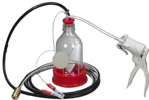
**Préleveur spécialement** conçu pour le prélèvement de **liquides inflammables** de classe de risque AI.
