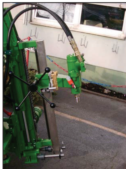
Système hydraulique de carottage avec fixation avant
