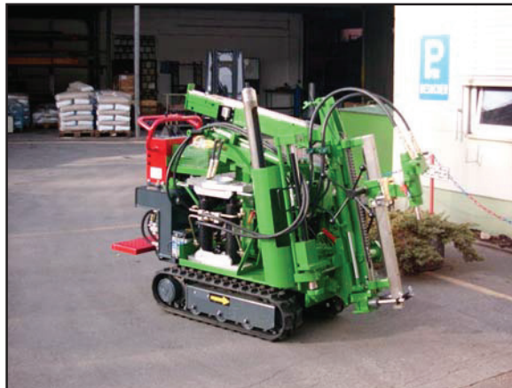
MRBZ avec système hydraulique de carottage
