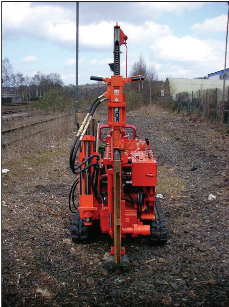
MRZB avec batteur hydraulique en position de travail
