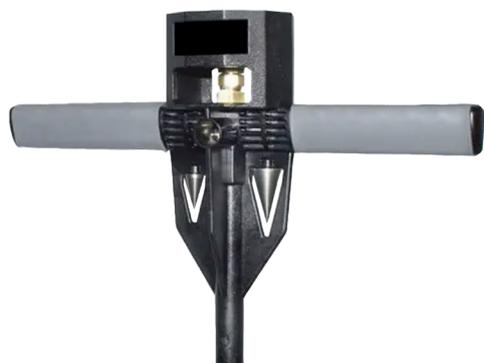
Les pénétromètres de sol sont utilisés pour déterminer la densité du sol et d'autres matériaux. Un opérateur pousse une tige avec un cône (norme ASAE) dans le sol. La résistance du cône s'affiche au fur et à mesure qu'il est enfoncé dans le sol.
