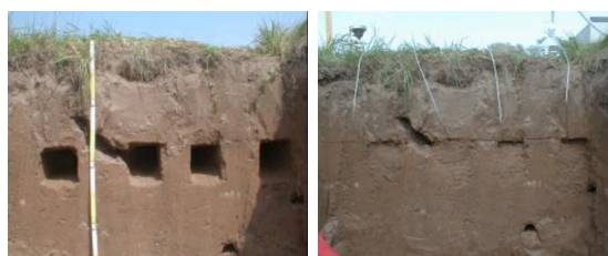
Fosse pédologique avec tunnels d'installation ouverts (à gauche) et après installation de quatre plaques en verre (à droite)
