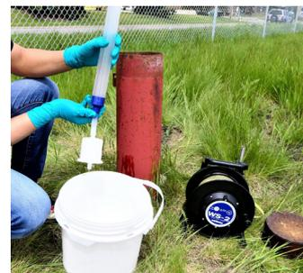
\* Bailers réutilisables (inox, téflon) sont en matériaux plus inerte que les jetables PTFE > Inox > PEHD > PVC. Chaque matériau a ses propres avantages et inconvénients en fonction des conditions spécifiques d'utilisation. Le choix du matériau dépendra des exigences précises de l'application, notamment de la nature des contaminants à surveiller et des conditions environnementales.
