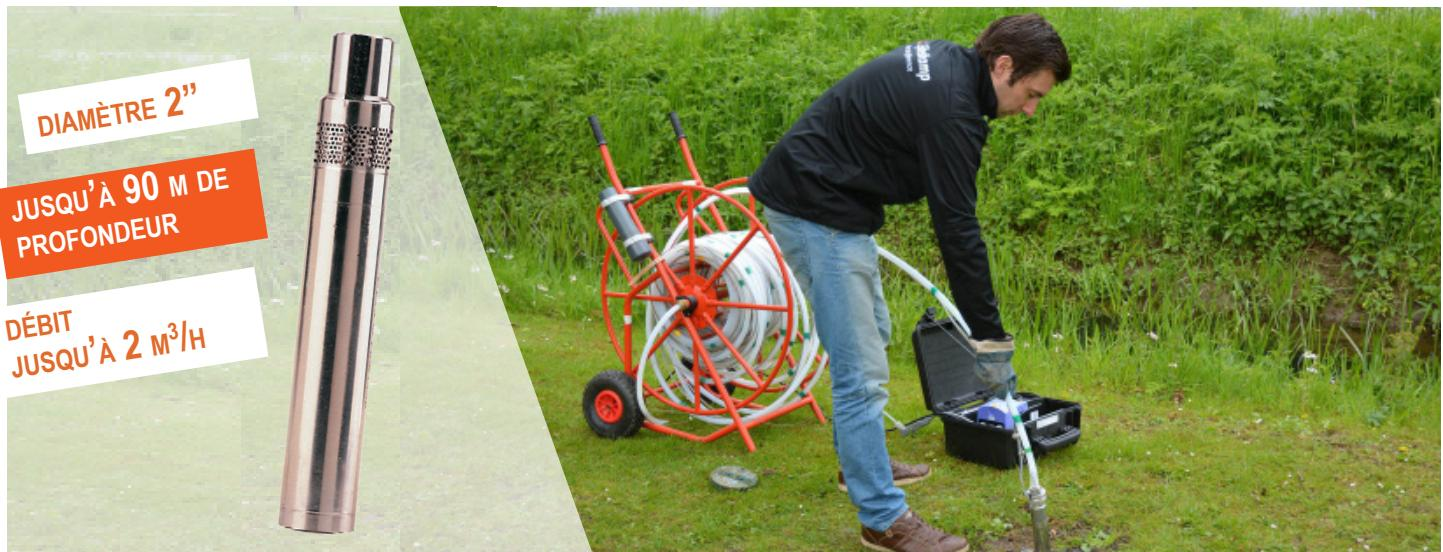
La MP1 est une pompe en inox destinée à la surveillance de l'eau (purge et échantillonnage), pour utilisation dans les forages de diamètre 2" et plus. Elle permet de prélever jusqu'à 90 mètres de profondeur des échantillons d'eaux souterraines pour analyses.
