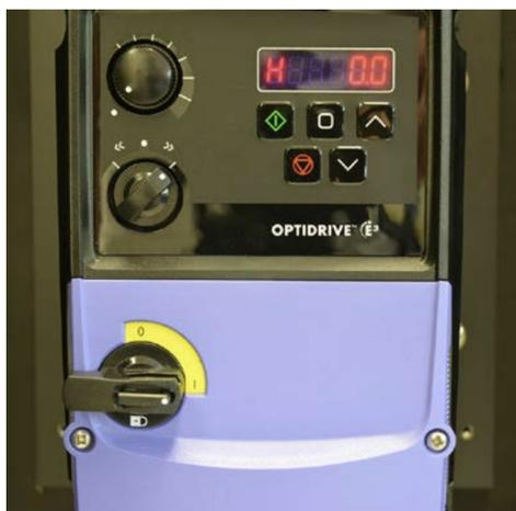
Fig. 8b Bouton 1 réglé sur ON
